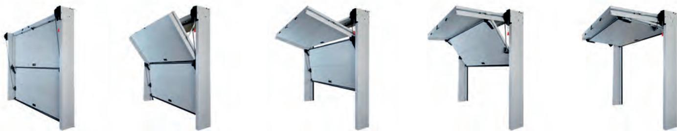
Il funzionamento di Overlap: l'anta si solleva, si piega a metà, ruota sotto il soffitto, si divide in due parti con l'inferiore che scorre sotto la superiore.
